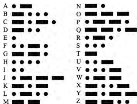
图 6 利用振动数量和长短编码的摩斯电码触觉文字
